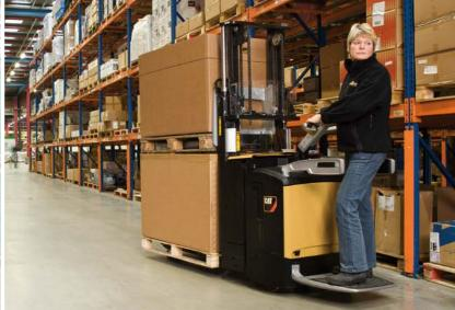
Il modello **NPV20ND** è stato progettato per garantire un trasporto efficiente e permette di movimentare due pallet contemporaneamente. Poiché può impilare 2 livelli di pallet uno sull'altro, questo carrello è l'ideale per caricare e scaricare autocarri.
