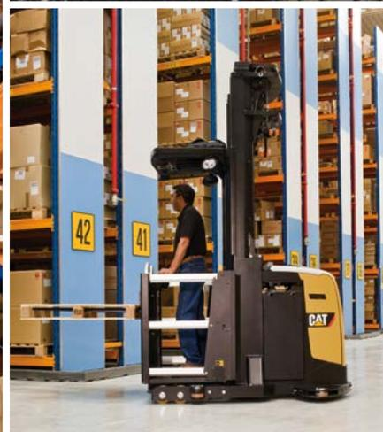
*(Raffi gurazioni in senso orario, partendo da sinistra) L'NOH10NH con montante triplex permette altezze di prelievo fino a 11,5 metri.*
